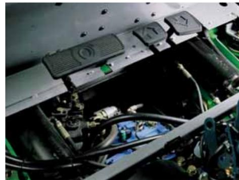
El alojamiento de la dirección asistida hidráulica, debajo de la plataforma, permite obtener una simplificación de las conexiones y reducir los ruidos de marcha. La racional disposición de los componentes en el interior del chasis facilita el acceso a los mismos permitiendo un rápido y eficaz mantenimiento.
