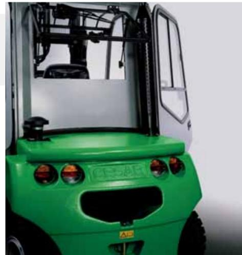
La cabina completa, disponible como opción se monta en el interior del perfil de las barras de protección. En su configuración estándar está equipada con revestimientos, accesorios y cuidadas insonorizaciones, techo en lexan con canales, cristal corredizo y limpiaparabrisas de pantógrafo.
