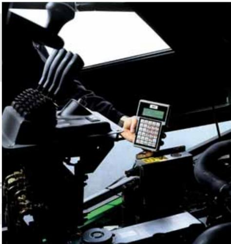
El control electrónico permite una perfecta sincronización entre la transmisión hidrostática, el motor térmico y la instalación hidráulica. Aceleración automática del motor con la elevación.
