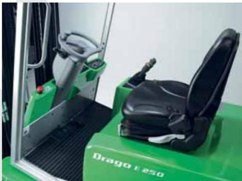
Ergonomía de los mandos. Las palancas hidráulicas, el conmutador rotativo del freno de estacionamiento, y el botón de emergencia, se encuentran al alcance de la mano y son fácilmente accesibles para el conductor. La nueva columna de la dirección, que se encuentra inclinada hacia el operador es fácilmente regulable y aumenta el confort de conducción.
